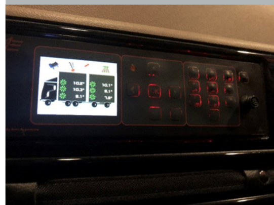
Abb. 3: Temperaturüberwachungssystem in Fahrerkabine des LKWs
