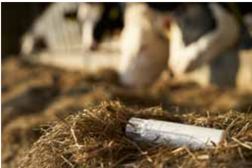
Firmen, die Sensoren anbieten, sind auch Partner im Projekt D4Dairy. Das Bild zeigt einen Pansenboli der Firma smaXtec, der dazu dient, Vorgänge direkt im Pansen der Rinder zu messen. Foto: smaXtec
